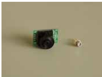
写真3: 左: CCD、右: フォトダイオード
