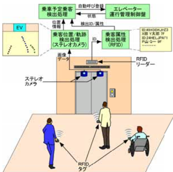
図1. RFIDとステレオカメラを利用したエレベーター呼び登録システム
