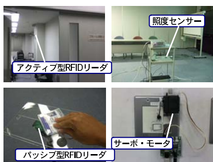
図 7 センサー・アクチュエータ群の配置
