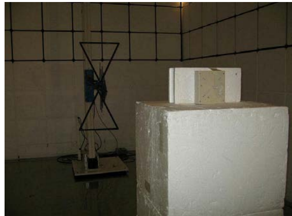
図 9. ComPass センサーノードの性能試験の様子(手前が ComPass センサーノードで奥が計測用標準アンテナ。間隔は試験規定により 3m である)
