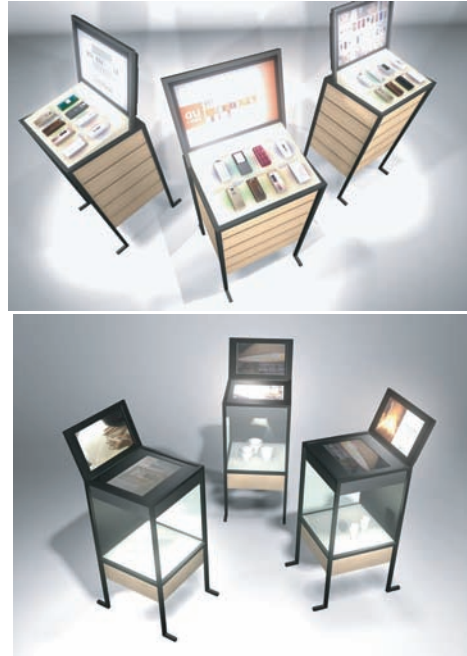
図 5 Smart Furniture3.0: シンクノード、液晶ディスプレイ、商品の展示スペース、商品棚、レーザレンジファインダ、組み込み PC を備える知的家具
