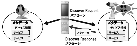
図 2 メタデータとデバイス・サービス探索
