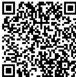
図10 2次元バーコード(QRコード)の例。 (記述内容は“バーコードと2次元 バーコードの本質的な差について”)
