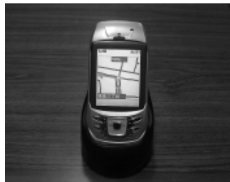
図12 半自律型GPS搭載携帯電話
