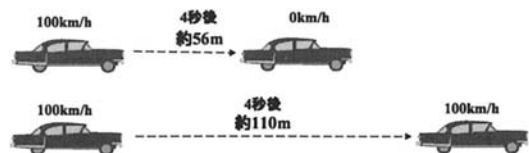
図 3 急停車時の等速運動を仮定した場合の予測位置に対する誤差
