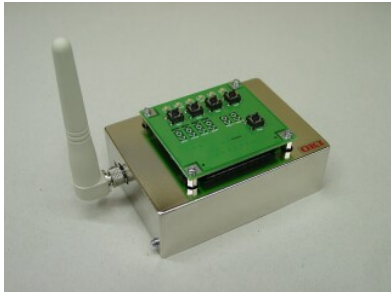
図7: 演算処理時間の測定に用いた実機 (CPU: ARM-7, クロック数: 16 MHz)
