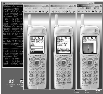
図 2 プロトタイプシステム上で仮想 Peer として動作する (株) クイックサーチが開発した携帯電話機エミュレーションソフトウェア 919 シミュレータ
