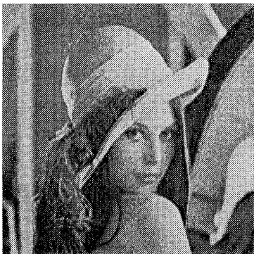
図 13: 閾値 153、量子化ステップ 30(MSE=60.10, PSNR=30.3dB, 0.70bits/pixel)
