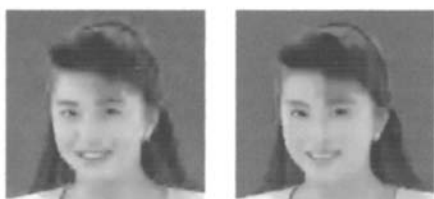
図 4.8 Chromakey における顔部分の拡大図 (左:JPEG 2000 圧縮 右:H.264 Intra 圧縮)
