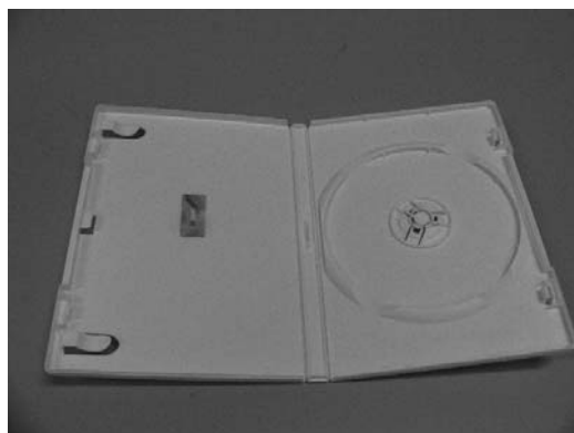
図 3 実験での IC タグの使い方 Fig.3 IC tags in dvd case
