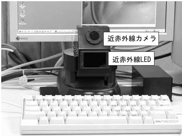
図 8: 試作した視線測定装置．上部に近赤外線カメラ，その下に近赤外線 LED がある．
