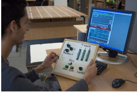
図 5: Pin&Play によるユーザインタフェースの構築例 や雨戸といった複数の装置を操作する際には、それぞれのデバイスを最も近い位置にある装置に対応付けられれば設定の手間が省ける。ユーザインタフェースを構築する例では、デバイスの位置関係からアプリケーションでの意味づけを自動的に設定できるようになる。
