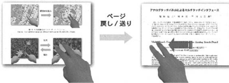
図 13 2 点間タッチを利用したページ戻し/送り UI Fig. 13 User Interface using Two-Points Touching (Page Return/Skip UI).
