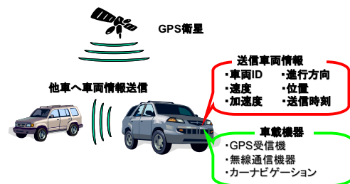
図 2. 伝播する車両情報と搭載機器
