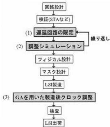
図 2 提案手法のフローチャート Fig. 2 Flow chart for the proposed method
