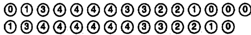
図 1.3 Dadda Tree 型部分積加算アルゴリズムを用いた 8 ビット乗算回路の部分積
