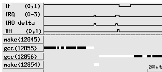
図 7 プロセス・割り込み状態の図式化 上段から、IF が割り込み許可フラグ、IRQ が割り込み処理中を示す値 (ネストすると 2 以上)、IRQ delta が IRQ 発生回数、BH が bottom half 実行中のフラグである。下半分は動作中のプロセス名と PID で、黒線がユーザモード、白線がカーネルモードを示す。時間軸に沿って、左から右へ描画される。
