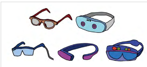
■図-2 最近流行のスマートグラスの5つのタイプ 上段が最近の流行で，普通のメガネに見えるスマートグラスとカラーパススルーゴーグル。下段がこれまでの流行で，両眼接続型グラス，業務用単眼グラス，光学シースルー AR ゴーグル。
