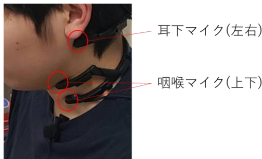
図 1. 皮膚接触型マイクの装着例
