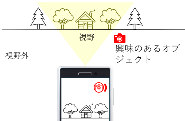
図 2: TRG(提案手法)による視野外オブジェクトを表示するスマートフォン UI の例
