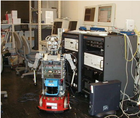
図1 ヒューマノイドロボット“ROBISUKE”と7台の外部サーバ・クライアントPC
