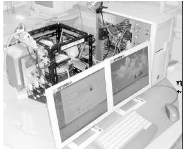
図 5 HDD 振動特性計測システム全景
