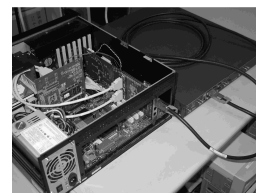
図 8 DIMMnet-1-bDais-InfiniBand スイッチの接続
