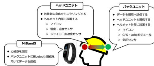
図1: 環境情報・生体情報を測定するモジュールの概要
