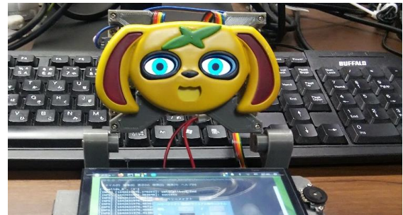
図 5 EyeROS で実現した犬型ロボット
