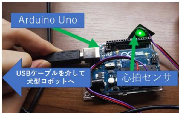
図7 使用した心拍センサとマイコンボード
