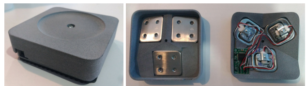
図1 ロードセルを傾斜配置した3軸荷重センサ
