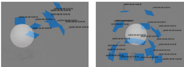
(1) キャリブレーションなし (2) キャリブレーションあり 図3 計算したカメラ位置比較
