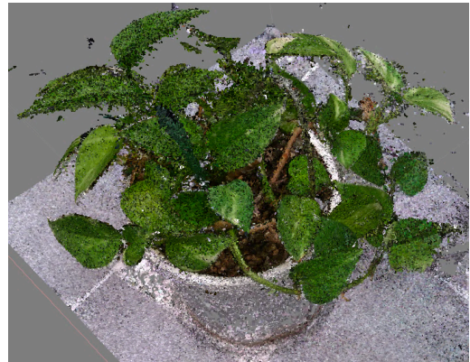
図5 90枚写真から生成した3Dモデル
