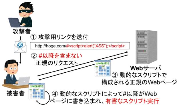
図2 DOM Based XSS の仕組み
