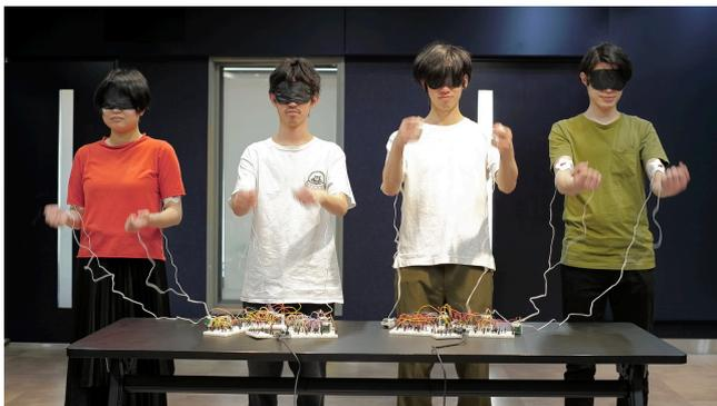
図 8 EMS システムによる伝達時間遅延の検証実験
