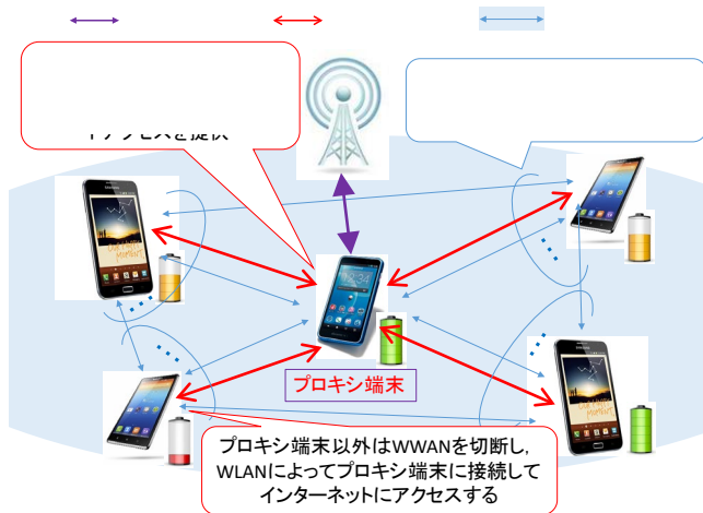
図 1 端末間協調省電力フレームワークのコンセプト Figure 1 Concept of a terminal-to-terminal cooperative power saving framework.
