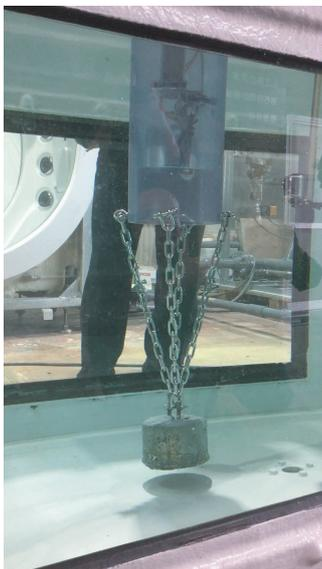
図 3 水中給餌装置のプロトタイプの外観
