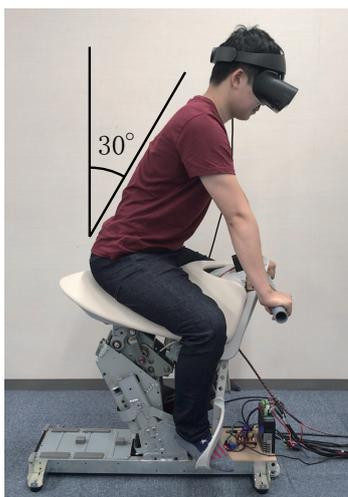
図 5 垂直方向加速度提示装置上で前傾姿勢をとる被験者
