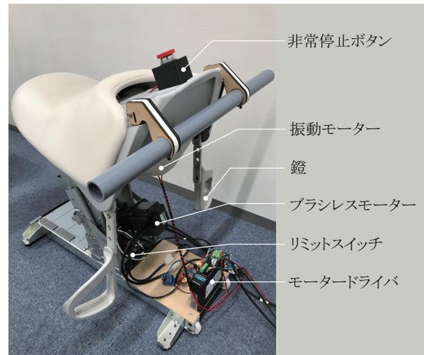
図1 垂直方向加速度提示装置
