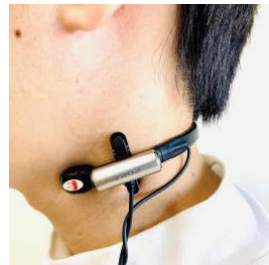
図 1 人型ロボットとの会話音声収録の様子 図 2 咽喉マイクと集音マイク
