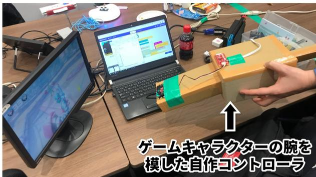
図 17 ゲームキャラクターの腕を模したコントローラの作例
