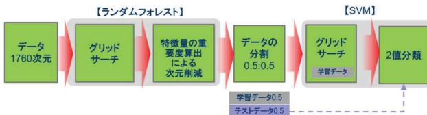
図 19 特微量の次元削減と分類
