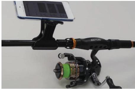
図 5 釣竿への iPod Touch の取り付け
