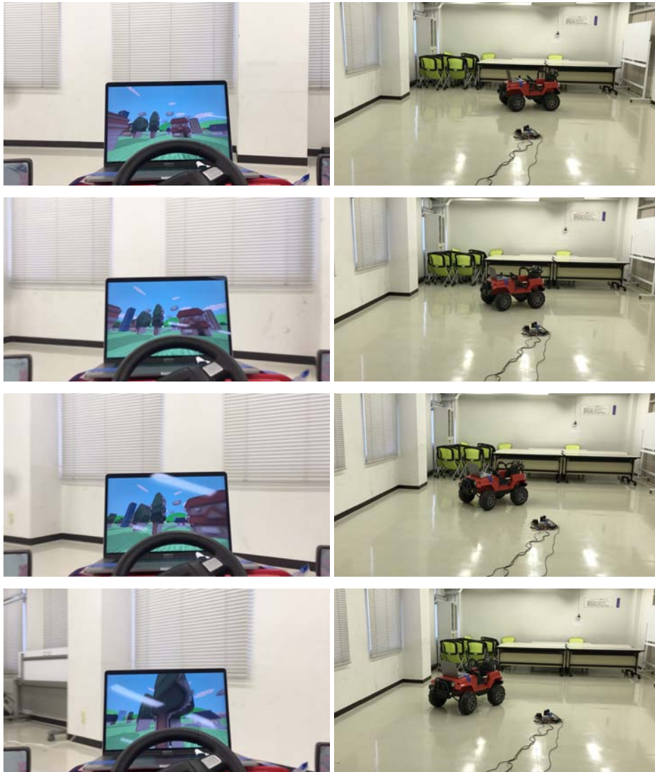
図 9 実空間のカートと 3DCG 空間の仮想カートの移動の同期の様子
