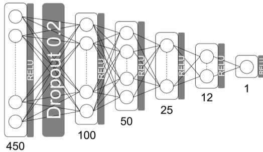
図 11 進行方向推定モデル
