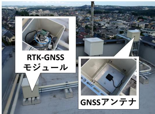
図 2 東京高専情報工学科棟屋上の RTK-GNSS 基地局
