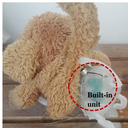
図 4 おもちゃへの音スイッチユニットを組み込み
