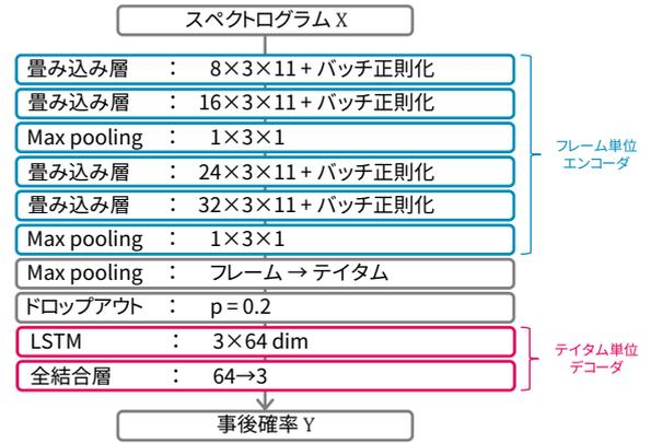
図 2 CRNN の詳細図。モデルはフレーム単位のエンコーダとテイタム単位のデコーダから構成され、max pooling を利用してフレーム・テイタム間のアライメントをとる。エンコーダは畳み込み層 4 層と max pooling 2 層、デコーダは GRU 3 層と全結合層 1 層から構成される。
