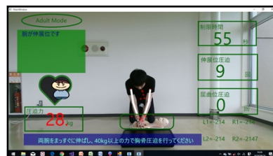
Fig.1 圧迫時に必要な情報を表示し可視化
