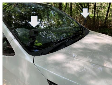
図5 カメラの設置位置
