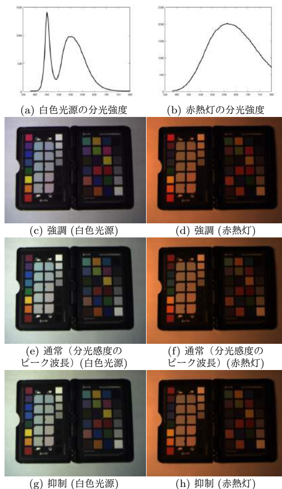
図3 各光源の分光強度と光源下のカラーチェッカーの様子
