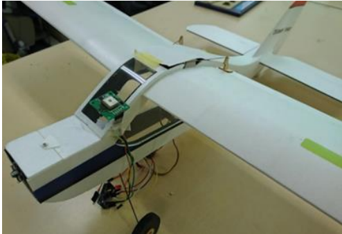
図 2. GPS モジュールを搭載した模型飛行機
