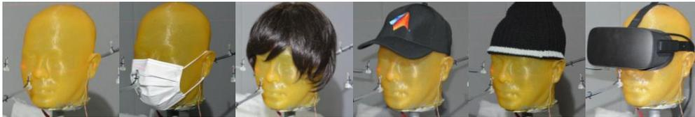
図 2: ダミーヘッド (左から Naked, Mask, Wig, Cap, Beanie, HMD)
