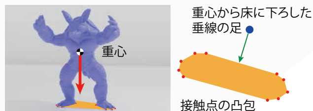
図-2 三次元物体を床に安定に立たせるための条件
